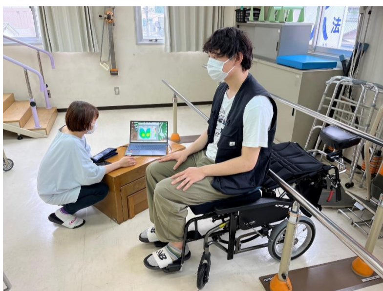
（卒業研究の準備の様子）体圧分布センサーを用いて体圧を測定しているところです
